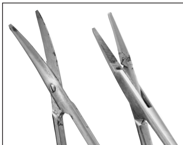
Perforierende Korrosion verursacht durch Chloride Perforating corrosion due to chloride Corrosione perforante causata da cloruri Perforacijska korozija izazvana kloridom
